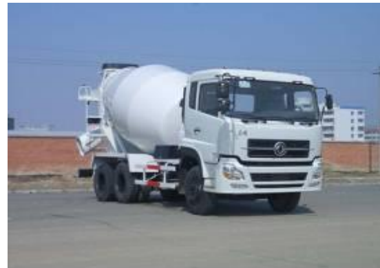
Xe trộn bê tông
